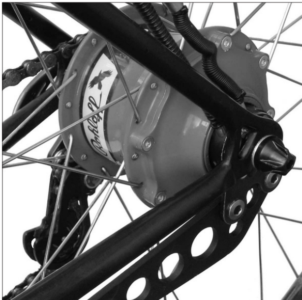
Rohloff SPEEDHUB 500/14 CC met lange draaimomentsteun
