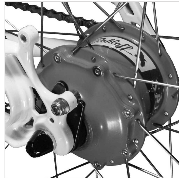
Rohloff SPEEDHUB 500/14 CC OEM2 gemonteerd met steunschroef
