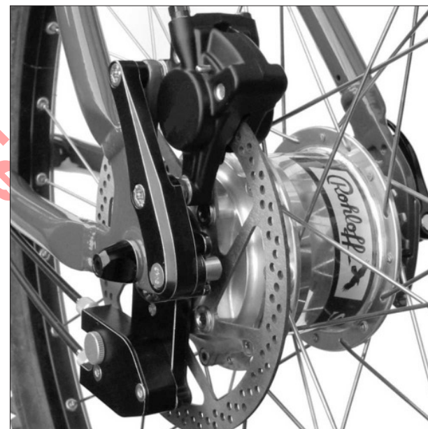
Rohloff SPEEDHUB 500/14 CC DB OEM2 gemonteerd met Rohloff SPEEDBONE en schijfrem
