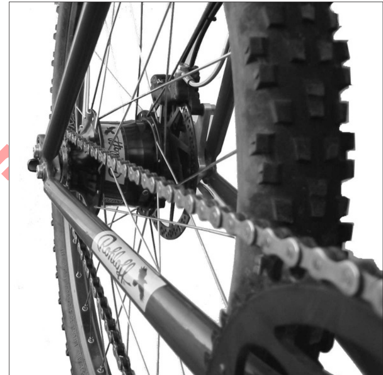
Rohloff SPEEDHUB 500/14 CC DB OEM gemonteerd in een frame met verschuifbare Rohloff OEM uitvaleinden
